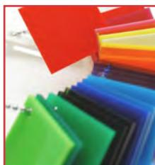
➤ **Le PMMA possède une excellente transmission lumineuse, une bonne aptitude au thermoformage et un aspect de surface très intéressant qui en font un des matériaux préférés des designers.**
