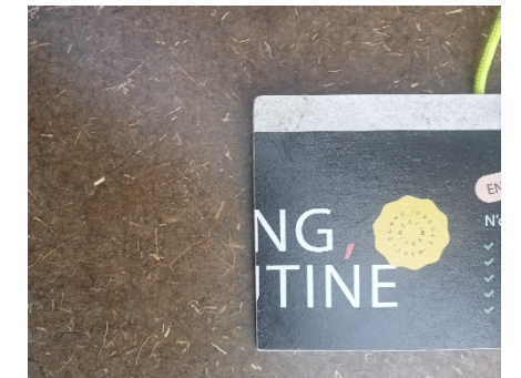
Réf. MONTBRLN0261 : Bonne tenue mécanique, impression UV restée intacte alors que la surface non imprimée a subi le vieillissement après exposition en extérieur pendant 3 ans.
