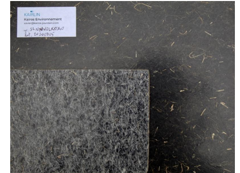
Réf. SLNNNOLK0340 : Bonne tenue mécanique, surface rugueuse, blanchiment des fibres du Kairlin® noir après exposition en extérieur pendant 7 mois
