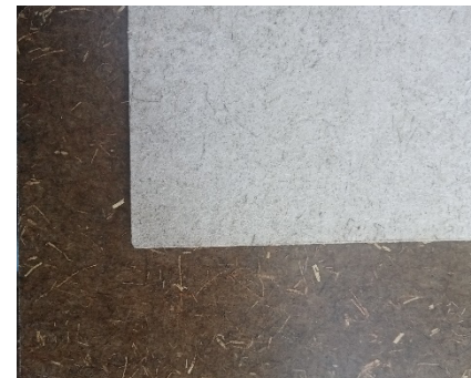
Réf. MONBRLN0319 : Bonne tenue mécanique, surface rugueuse et blanchiment des fibres du Kairlin® brun après exposition en extérieur pendant 3 ans.
