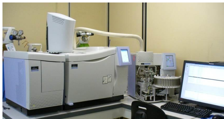
Figure 2 : Photographie du système de Thermodésorption couplé au GC/MS/FID / Photography system Thermal desorption coupled to GC / MS / FID
